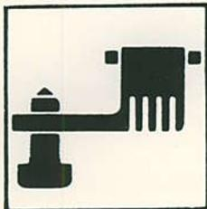
Zeigt an, daß der Abrichterarm ausgeklappt ist.
